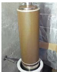
【汚れたフィルター】
